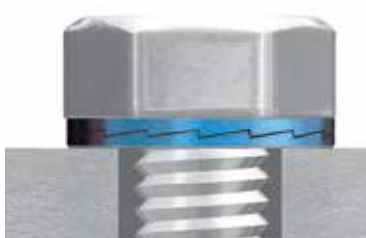
Kiilahammastukset kiinni – oikein
