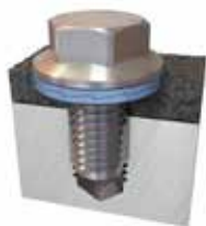
Pièces serrées à faible résistance en compression
